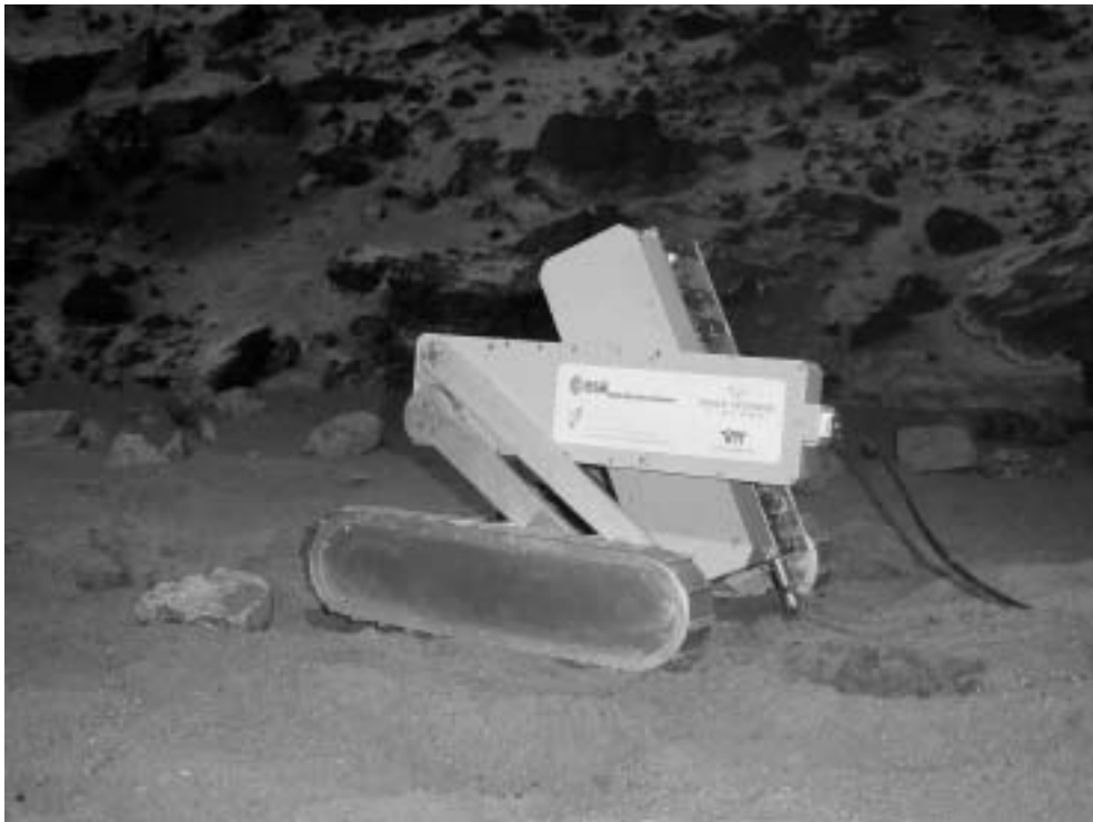
Suomessa Euroopan Avaruusjärjestön ESA:n toimeksiannosta kehitellyn MIRO-Mars-pintakulkijan malli (ks. s. 7) ESA:n teknisessä keskuksessa ESTEC:ssä testattavana luovutuksen yhteydessä 29.11.2001. Kuva: Space Systems Finland.
