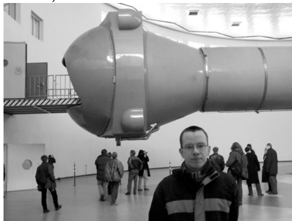
Kuva 3. Suuri sentrifuugi tähtikaupungissa. Liikkuvan osan massa yli 200 tonnia. Käynnistysteho noin 25 MW, pyöritysteho 8 MW. Omat sähkölinjat voimalaitokselta. Kuva: Mikko Suominen
