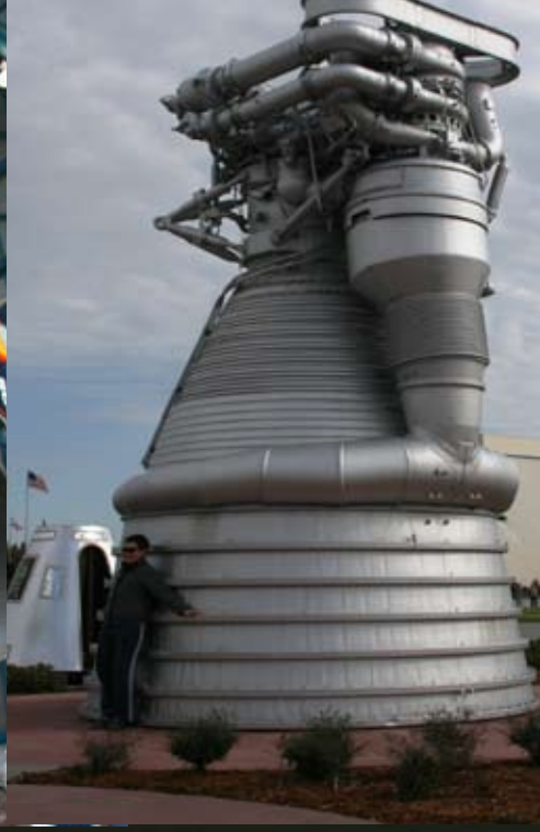
Turusen kuvia JFK Space Centeristä. Yllä historian havinaa. Yli kolmen sukkulamoottorin tehoinen Saturn V:n F-1 moottori.
