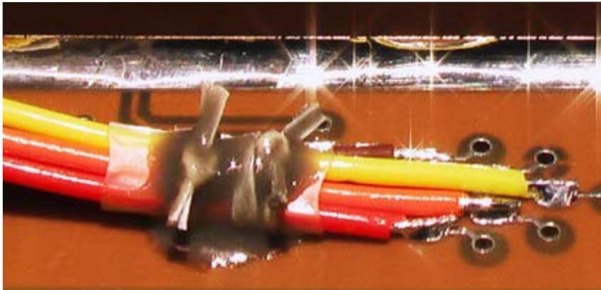
Johdot sidotaan piirilevyyn. Varmistus liimalla.
