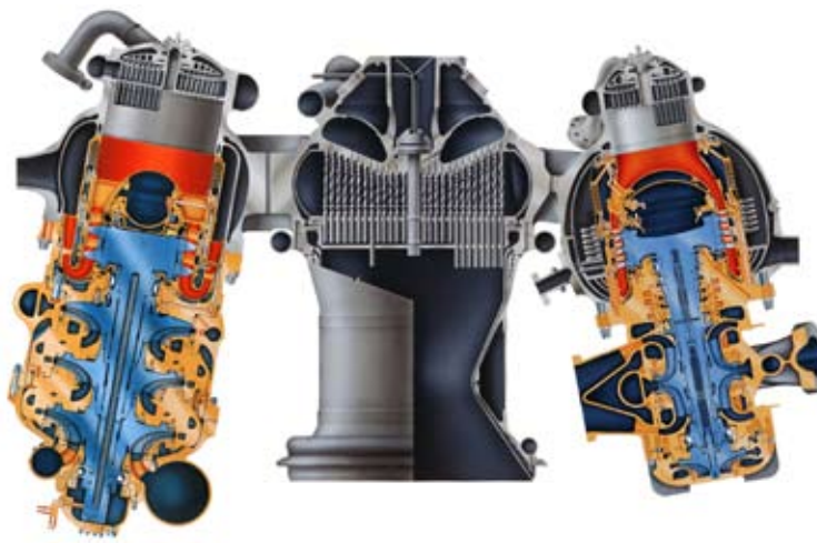
Sukkulan SSME-päämoottorissa on erilliset turbopumput vedylle ja hapelle. Vasemmalla vedyn ja oikealla hapen. Kummallakin on yläosassa oma kaasugeneraattori / esipoltin (harmaa), keskiosassa turbiini (punainen) ja alaosassa varsinainen pumppu (sininen). Keskellä kuvaa turbopumppujen välissä on moottorin injektori ja pääpoltokammio. Moottorissa on lisäksi matalan paineen esipumppu, mutta niitä ei ole kuvassa. Myös jäähdytysenergiaa käytetään pumppaamiseen. Vetypumppu on isompi, koska pumpattavan vedyn tilavuus on paljon suurempi. Pumput myös pyörivät eri nopeudella. kuva: Pratt & Whitney tms.
